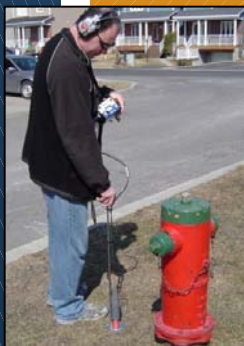
Détecteur DF junior avec capteur magnétique
