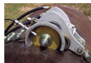
Coupe-tuyau hydraulique autotracté
